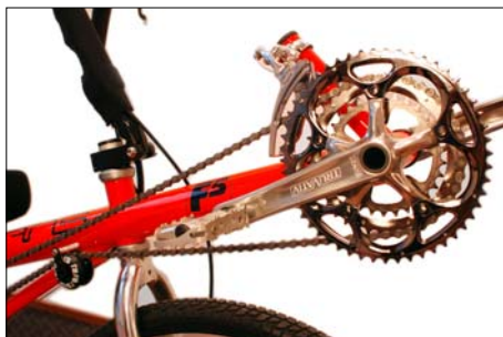
A rövid tengelytávú típusok hajtóműve jóval az első kerék tengelye előtt található.
