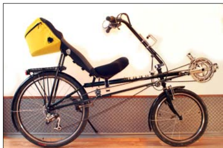
A RANs V-REX modellje a klasszikus rövid tengelytávú típus, elől 20°, hátul montis kerékmérettel.
