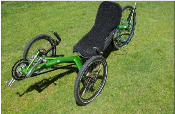
Challenge Trike, szányprofilszerű keresztartóval
