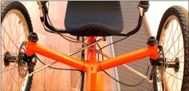
Jól látható, hogy kormányja alacsony, közvetett kereszturakkal működik.
