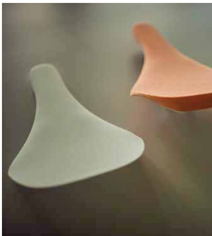
Früher 3D-Print der Sitzschale und CNC-gefräster Schaumkern
